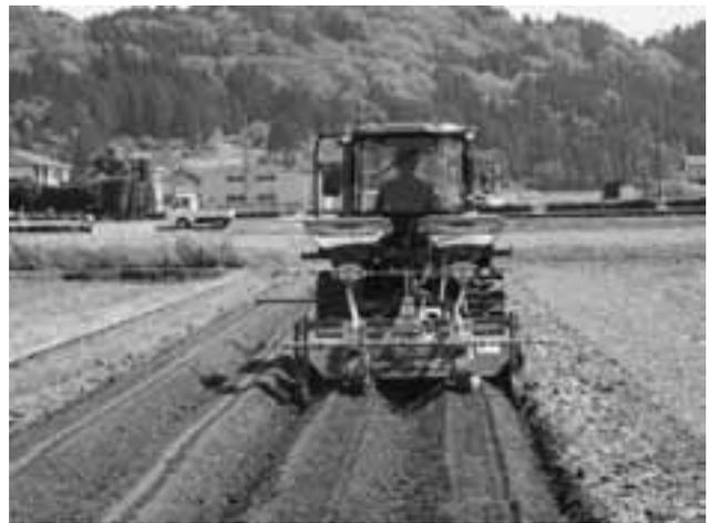
図9 (株) JA アグリひみに導入された耕うん同時畝立て播種機
