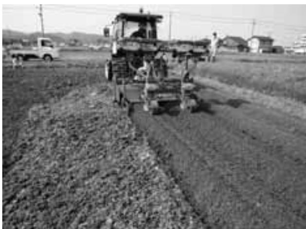
図4 供試した耕うん同時畝立て播種機
